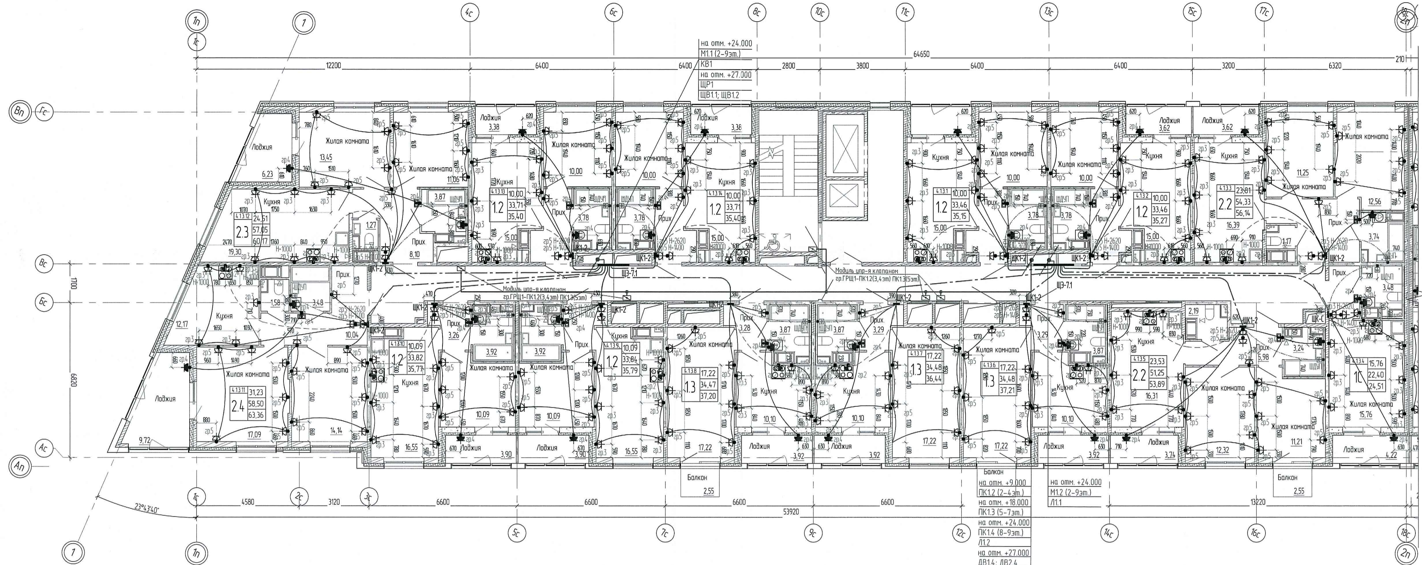
Эскиз установки закладных деталей для сетей электрооборудования в квартирах
