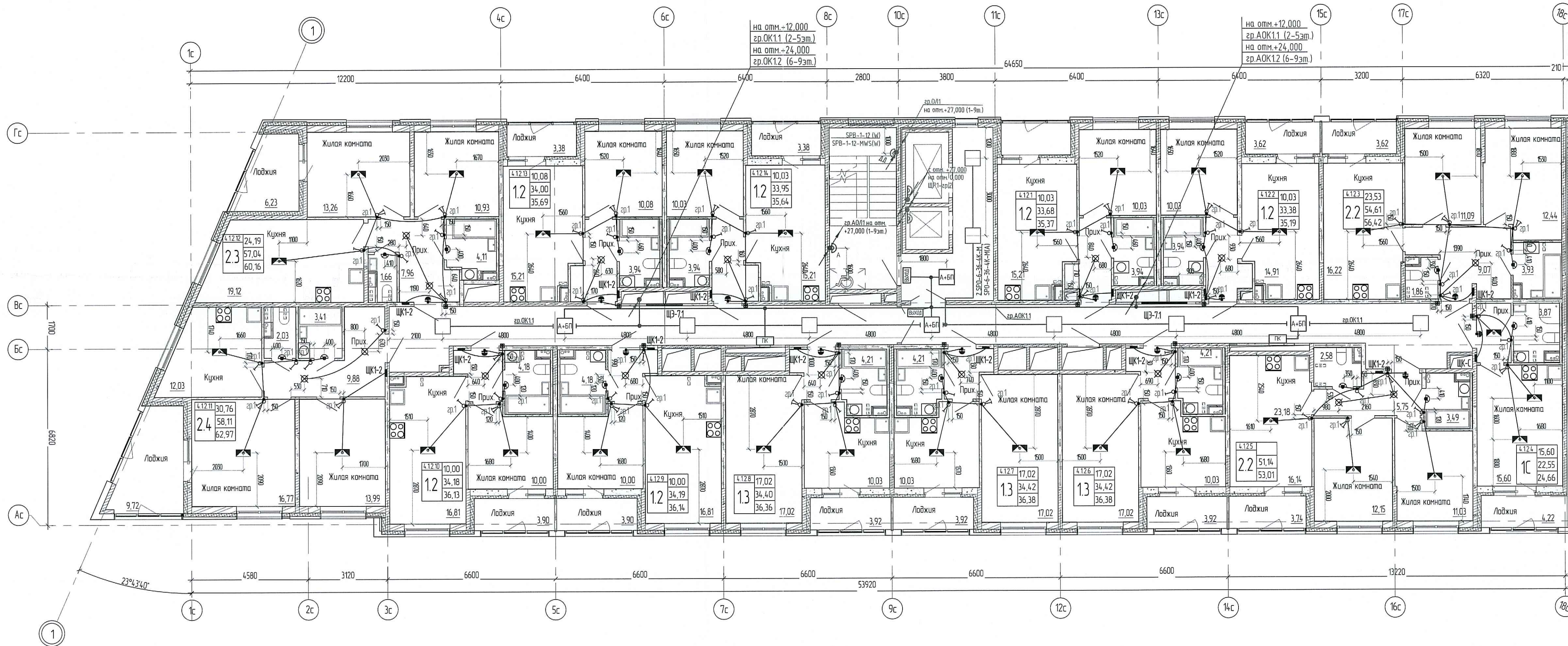
Схема установки закладных деталей для сетей освещения в квартирах
